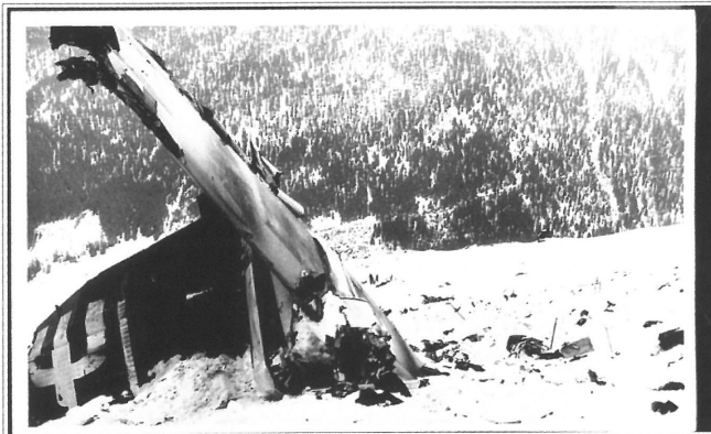
Aufgrund des massiven Aufpralls waren die Flugzeugteile der Unglücksmaschine in einem Umkreis von 500 m verstreut. Hier das Leitwerk mit dem Emblem der British Eagle International Airlines, welches 390 m unterhalb der Aufprallstelle aufgefunden wurde.
